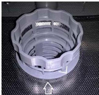
špatně zajištěný filtr
