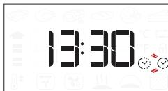
V prípade potreby otáčaním nastavovacieho ovládača nastavte želaný čas ukončenia pečenia, potvrdte stlačením a spustite funkciu.
