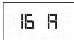
Otočením voliacoho gombíka vyberte menovitý prúd a potom potvrdte stlačením .
